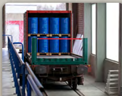
Praktische rijtests met containers op het spoor Practical driving tests with containers on rail
