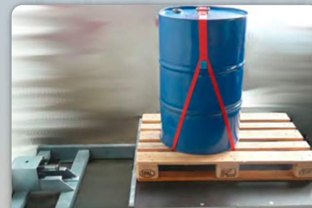
Mobiele horizontale schoktest system (HSPA) voor dynamische tests van laadeenheden Mobile Horizontal Impact Test Area (HSPA) for dynamic testing of unit loads
