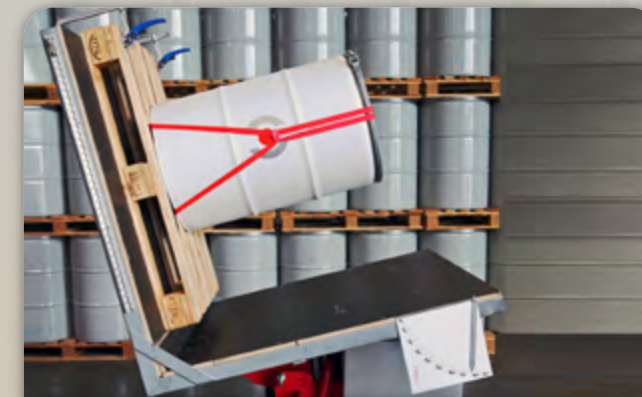
Mobiele kantenhoektestsystem (KWPA) voor statische tests van laadeenheden Mobile tilt angle test facility (KWPA) for static testing of unit loads
