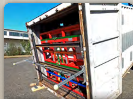
Op-slede voor het testen van zekering systemen onder statische omstandigheden Op-sled for testing restraining systems under stable conditions
