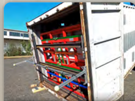
0µ-Schlitten zum Test von Rückhaltesystemen unter konstanten Bedingungen 0µ-sled for testing restraining systems under stable conditions
