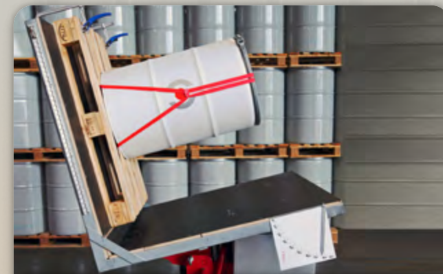
Mobile KippWinkel-PrüfAnlage (KWPA) für statische Prüfungen von Ladeeinheiten Mobile tilt angle test facility (KWPA) for static testing of unit loads
