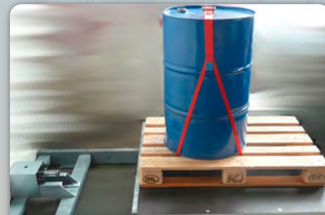
Mobile Horizontale StoßPrüfAnlage (HSPA) für dynamische Prüfungen von Ladeeinheiten Mobile Horizontal Impact Test Area (HSPA) for dynamic testing of unit loads
